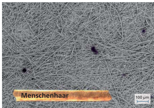
Abb. 5: Organische Partikel auf Glasfaserfilter (Rasterelektronenmikroskopische Aufnahme) mit Größenvergleich eines menschlichen Haars
