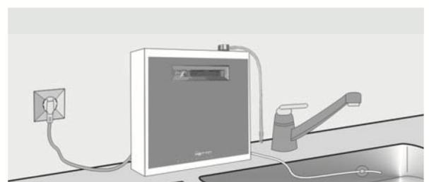
Es wird eine Installation am Wasserhahn – entweder freistehend oder als Wand-Montage – empfohlen. Das Gerät kann aber auch direkt an der Kaltwasserleitung angeschlossen werden.
